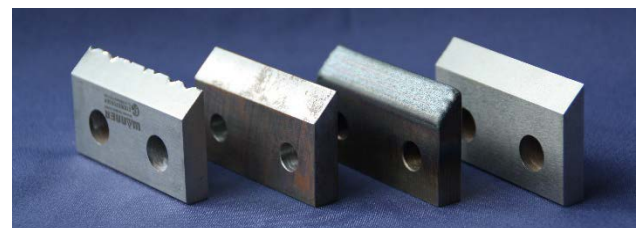
Bild: Reparaturschritte am Beispiel eines Schneidmessers
